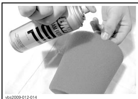
TYPIQUE - HUILER L'ÉLÉMENT EN MOUSSE
