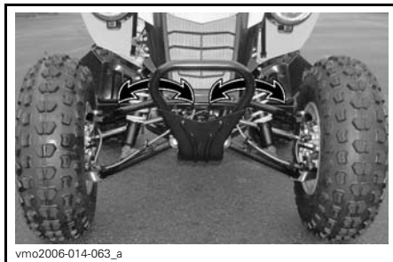
TYPIQUE — PARE-CHOCS AVANT: POINTS D'ARRIMAGE DES SANGLES
