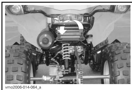
TYPIQUE — PARE-CHOCS ARRIÈRE: POINT D'ARRIMAGE DES SANGLES
