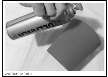
TYPIQUE - VAPORISER DU NETTOYEUR DE CHAQUE CÔTÉ DE L'ÉLÉMENT
