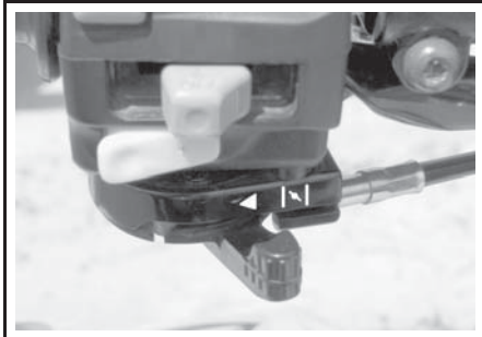
TÍPICO — PALANCA DEL ESTRANGULADOR DE AIRE EN POSICIÓN DE ESTRANGULADOR CERRADO
