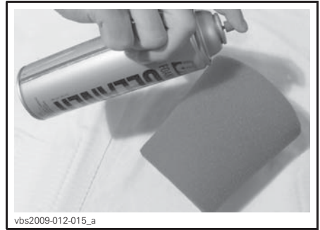
TYPISCH - SCHAUMSTOFFELEMENT INNEN UND AUSSEN BESPRÜHEN
