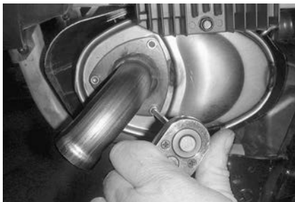
典型示例 - 拆卸尾管
