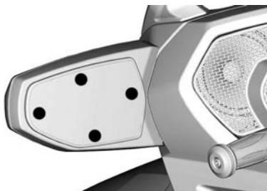
AFSTELPUNTEN VOOR DE SPIEGEL - MODEL T EN LIMITED
