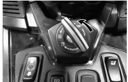
STAND VAN DE SLEUTEL OM HET VOORSTE COMPARTIMENT TE OPENEN
