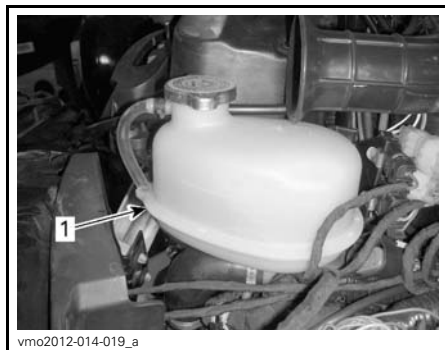
1. Réservoir de liquide de refroidissement
