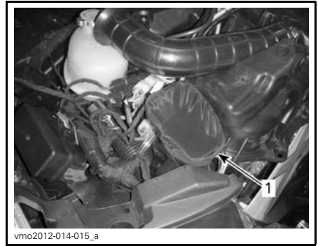
1. Filtre à air de la transmission CVC
