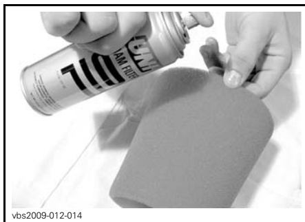
TIPIQUE - LUBRIFICATION DU FILTRE EN MOUSSE
