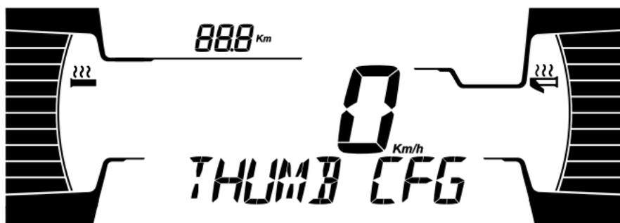
3. С помощью переключателя на консоли отрегулируйте баланс обогрева рукояток руля между большим пальцем руки и ручьятками согласно индикации на правой стороне дисплея.
