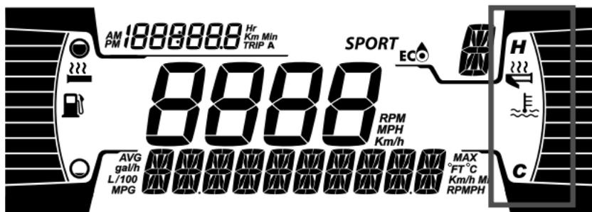
**ИНДИКАЦИЯ ОБОГРЕВА РЫЧАГА ДРОССЕЛЬНОЙ ЗАСЛОНКИ**
