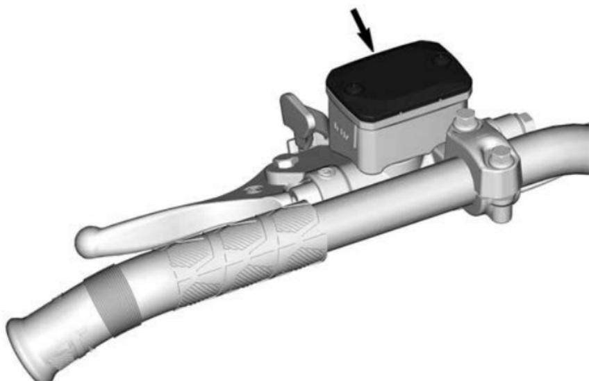
2. Снимите винты крепления крышки бачка.
