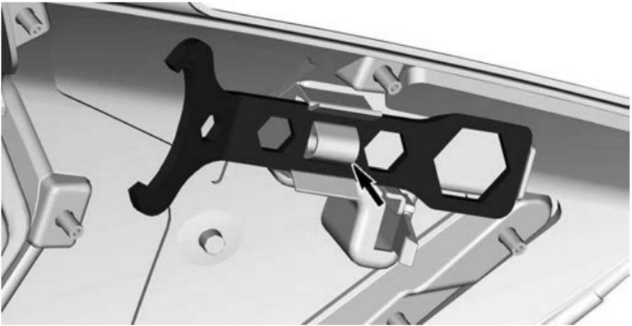
2. Вставьте длинный конец инструмента для разведения шкива и регулировки фар в отверстие.
