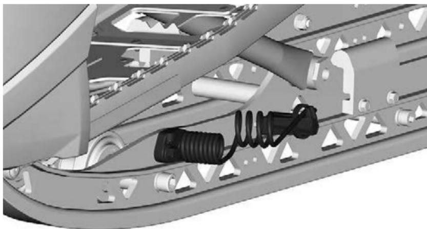
Скребки должны использоваться при эксплуатации снегохода на трассе, плотном снегу или льду.
