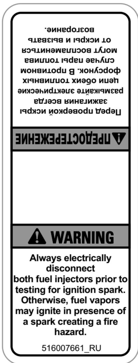
**ОТСОЕДИНИТЕ ТОПЛИВНЫЕ ФОРСУНКИ — ПРЕДУПРЕЖДАЮЩАЯ НАКЛЕЙКА**
