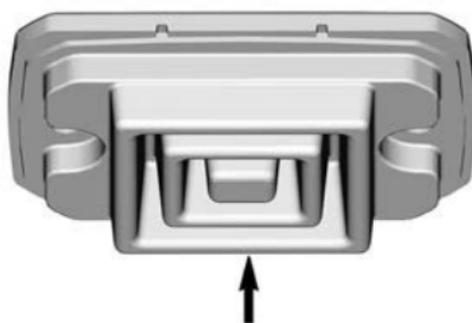
6. Установите на место крышку бачка и затяните винты. Затяните винты указанным моментом.
