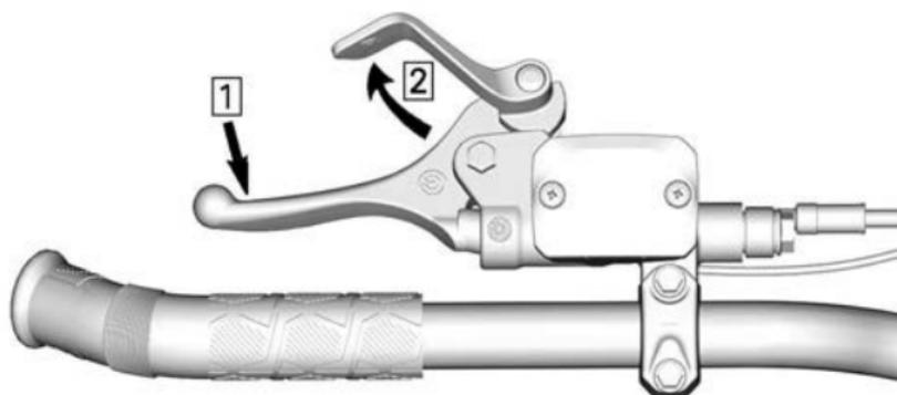
**ТИПОВОЙ ВАРИАНТ – ВКЛЮЧЕНИЕ СТОЯНОЧНОГО ТОРМОЗА**
