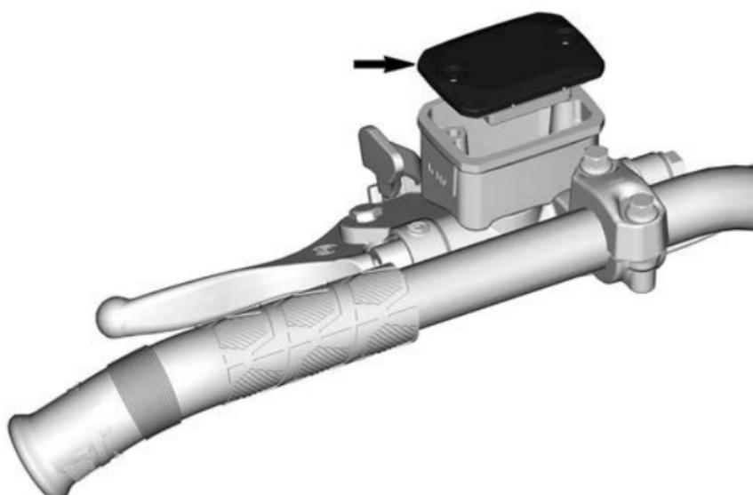
4. При необходимости долейте жидкость гидропривода сцепления. Не допускайте перелива. Используйте только рекомендованную тормозную жидкость. См. пункт «Тормозная жидкость» в этом подразделе.
