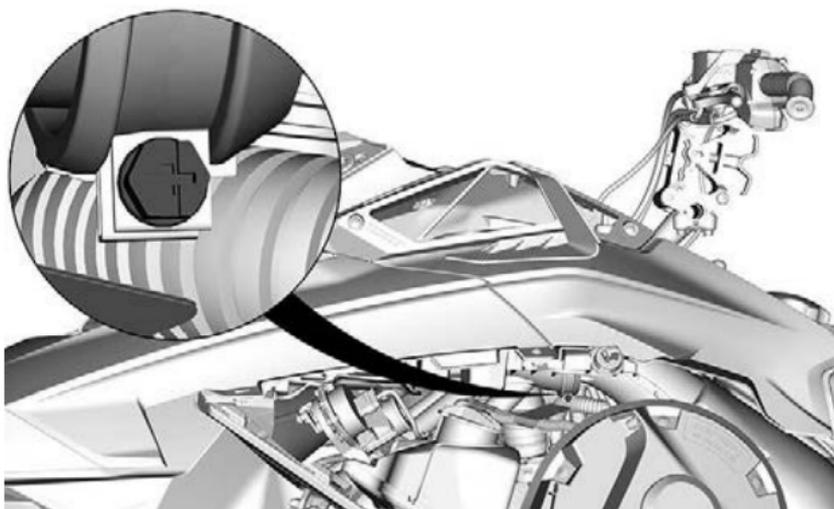
6. Снимите верхнюю панель корпуса.
