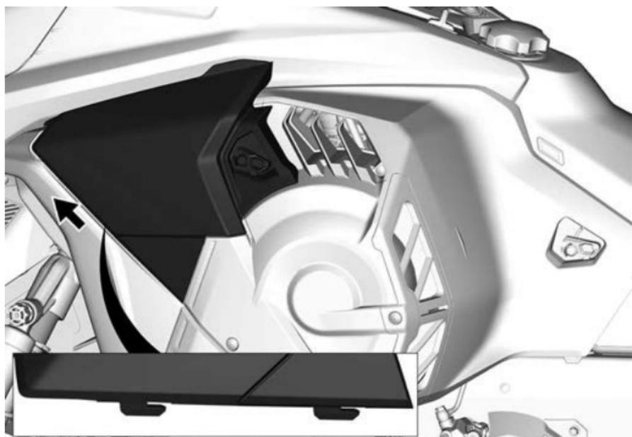
5. Разблокируйте предохранительную защелку ограничителя шкива и сдвиньте панель наружу.
