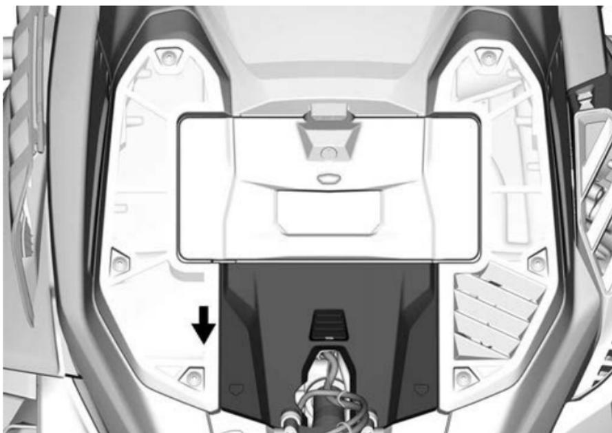
2. Проверьте уровень охлаждающей жидкости при комнатной температуре. Жидкость должна находиться на уровне плоской поверхности глазка.
