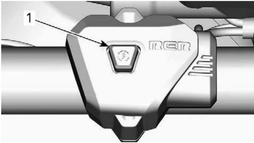
1. Кнопка запуска двигателя/включения электронного реверса
