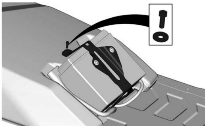
5. Снимите аккумуляторную батарею.
