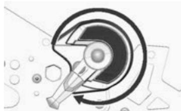
При поставке с завода регулируемый ленточный ограничитель настроен таким образом, что положение AGILE соответствует настройке № 4 на обычном ленточном ограничителе. Положение PRECISION+ соответствует настройке № 7 на обычном ленточном ограничителе.
