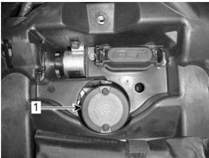
1. Компенсационный бачок заднего тормоза
