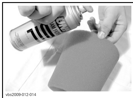
TYPISCH - SCHAUMSTOFFFILTER ÖLEN
