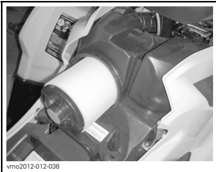
AUSBAU DES LUFTFILTERS
