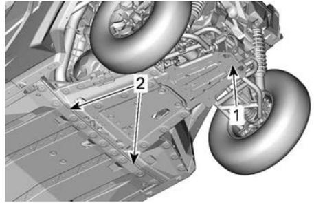
1. Hebestelle unter der Schutzplatte
