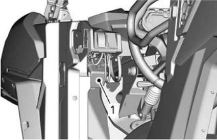
1. Vorderer Sicherungskasten
