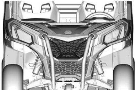
2. Überprüfen Sie den Kühler und die Schläuche auf Undichtigkeiten und andere Beschädigungen.
