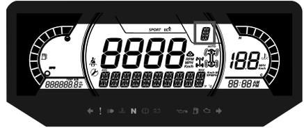
Diese Anzeige zeigt die Getriebestellung an:
