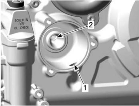
1. Einlass-Bohrung der Ölpumpe zum Ölfilter
