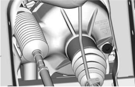
3. Entfernen Sie den Einfüllstopfen.
