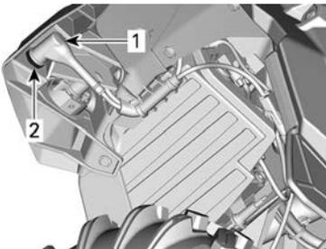
1. Positionieren Sie den elektrischen Steckverbinder der Leuchte.
