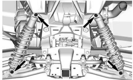
**TYPISCH – BEFESTIGUNGSTEILE FÜR HINTERE STOßDÄMPFER**
