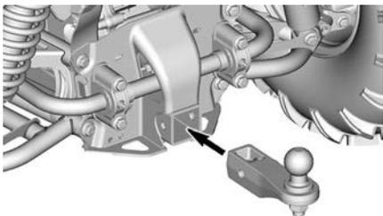
Stecken Sie den Stift durch die Zugstange und die Empfängerkupplung.
