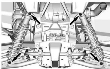
**SITUAZIONE TIPICA — DISPOSITIVI DI FISSAGGIO AMMORTIZZATORE POSTERIORE**
