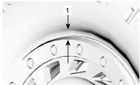
1. Distanza uguale in tutti i punti dell'anello della fascetta del dispositivo di bloccaggio
