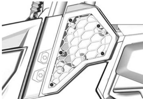
2. Rimozione del filtro dell'aria CVT.
