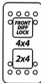
Questo selettore seleziona 2 ruote motrici o 4 ruote motrici quando il veicolo è fermo.
