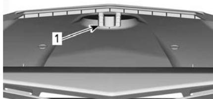
1. Fessura di posizionamento sul lato inferiore del coperchio di manutenzione
