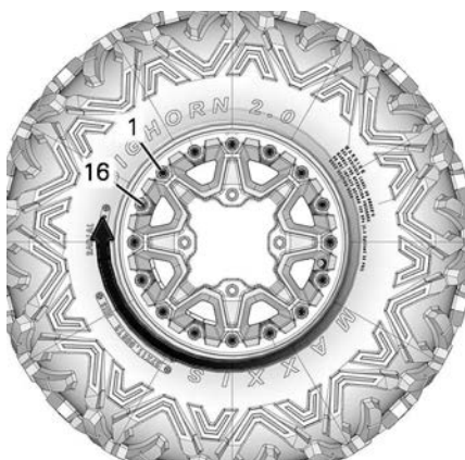
代表例 - 最後の締め付け順序
