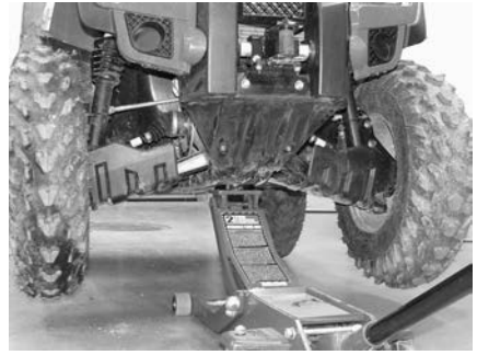
BILDET VISER – LØFTEPUNKT FORAN PÅ KJØRETØYET
