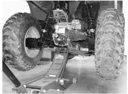
BILDET VISER – LØFTEPUNKT BAK PÅ KJØRETØYET
