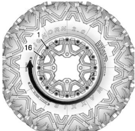
TYPISCH - LAATSTE AANDRAAIVOLGORDE
