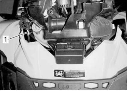
1. Réservoir du liquide de refroidissement
