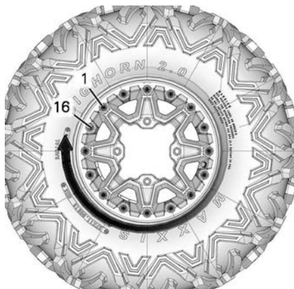
ТИПОВОЙ ВАРИАНТ - ЗАКЛЮЧИТЕЛЬНЫЙ ЭТАП ЗАТЯЖКИ ВИНТОВ
