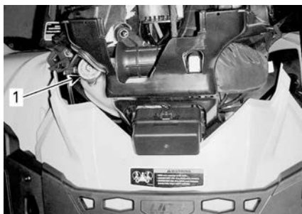
1. Serbatoio liquido refrigerante motore
