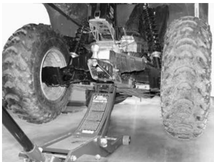
CONFIGURAZIONE TIPICA - PUNTO DI SOLLEVAMENTO POSTERIORE
