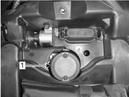
1. Behälter für Bremsflüssigkeit der hinteren Bremse
