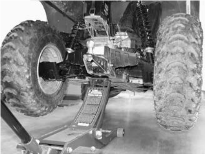
TYPISCH — PLAATS VAN HET KRIKPUNT ACHTERAAN
