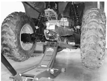
CONFIGURAZIONE TIPICA - PUNTO DI SOLLEVAMENTO POSTERIORE
