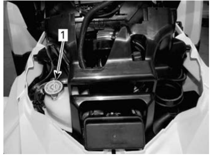
1. Réservoir du liquide de refroidissement
