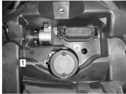
1. Depósito de líquido de los frenos traseros
