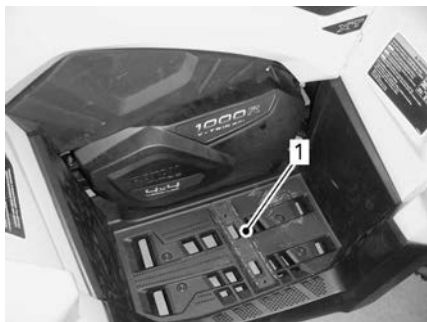
1. Estribo izquierdo del conductor
