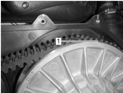
1. Het onderste deel van de tanden gelijk met de buitenkant van de aandrijfriem
