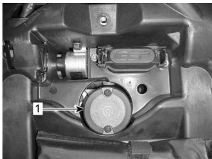
1. Réservoir de liquide de frein arrière
