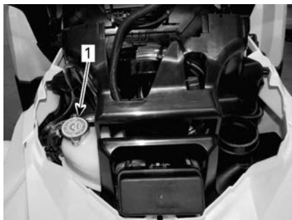
1. Réservoir du liquide de refroidissement
