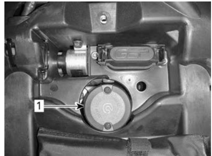
1. Behälter für Bremsflüssigkeit der hinteren Bremse
