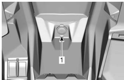
1. Электрическая розетка (12 В)
