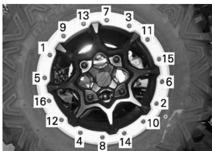
ТИПОВОЙ ВАРИАНТ - ПОРЯДОК ЗАТЯЖКИ ВИНТОВ
