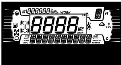
Exibe a velocidade do veículo em km/h ou MPH.
