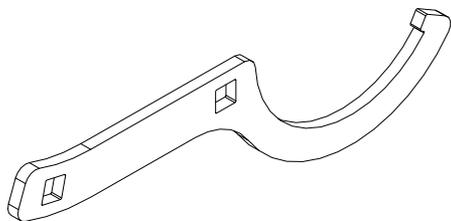
**FERRAMENTA DE AJUSTE DE SUSPENSÃO**
