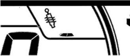
Este ícone é exibido e pisca quando se seleciona o modo de suspensão ou quando ocorre uma falha da suspensão.
