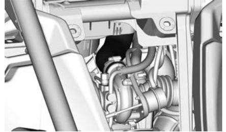
Remova o parafuso para abrir o intercooler e o suporte da mangueira do cárter.
