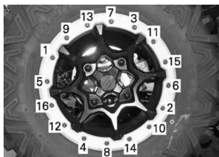
SITUAZIONE TIPICA - SEQUENZA DI SERRAGGIO
