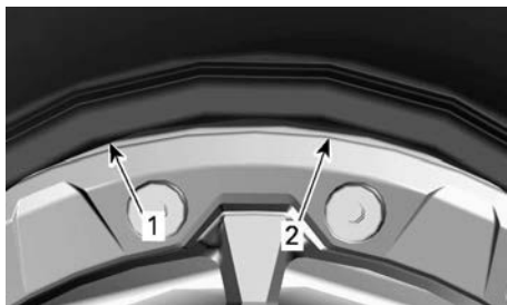
SITUAZIONE TIPICA - TALLONE ESTERNO DEL PNEUMATICO
