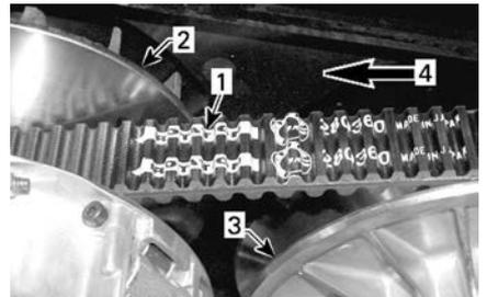
1. Flèche imprimée sur la courroie
