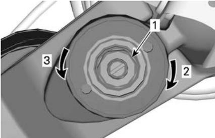
**AMORTISSEMENT DE COMPRESSION À HAUTE VITESSE (UTILISEZ UNE CLÉ DE 17 MM)**
