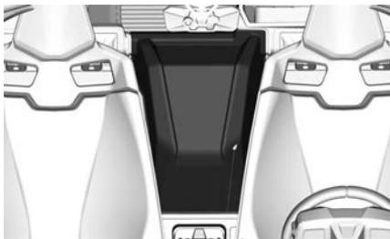
Retirez les vis de fixation retenant la plaque de protection avant.
