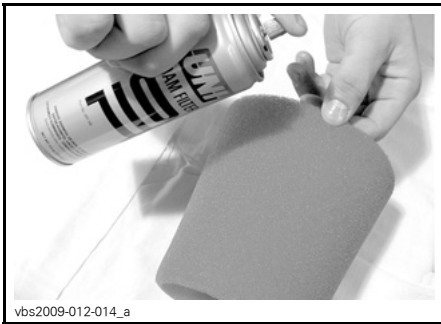
TYPISCH - SCHAUMSTOFFFILTERELEMENT ÖLEN
