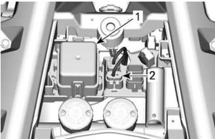
1. Vorderer Sicherungskasten
