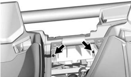
Entfernen Sie die Schutzplatte.
