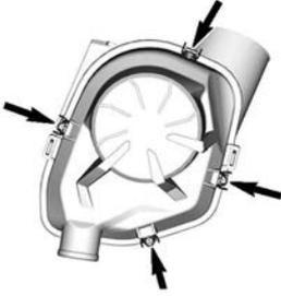
Entfernen Sie die Filterpatrone.
