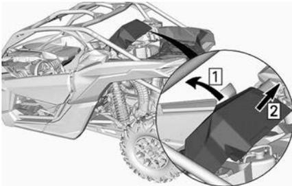
Entfernen Sie das CVT-Luftfilter vom Fahrzeug.
