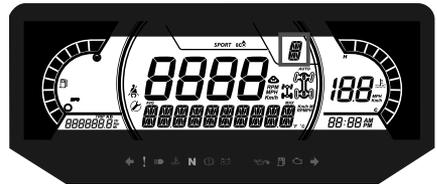
Diese Anzeige zeigt die Getriebestellung an:
