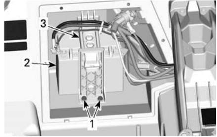
1. Halteschrauben des Batteriebügels
