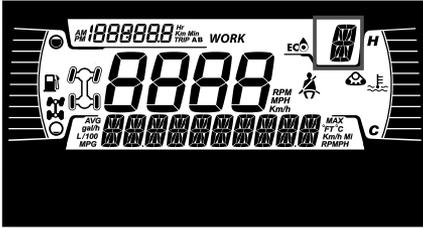
Diese Anzeige zeigt die Getriebestellung an:
