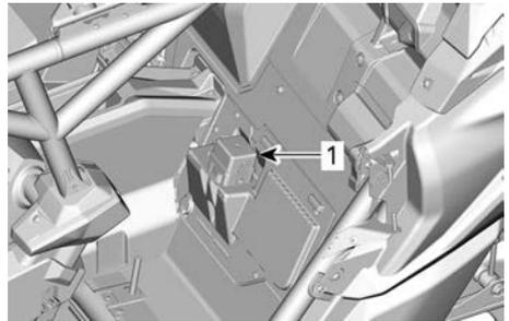
1. Hinterer Sicherungskasten
