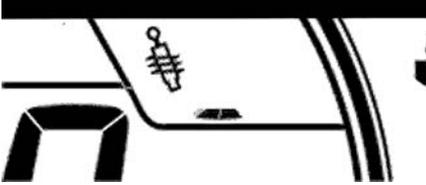
Cette icône apparaît et clignote lorsque vous ouvrez la sélection du mode de suspension ou lorsqu'une erreur de suspension se produit.
