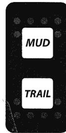
L'interrupteur permet de choisir entre le mode « TRAIL » ou « MUD » (PISTE ou BOUE).
