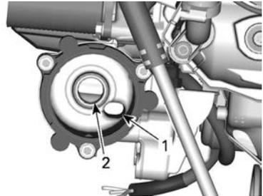
1. Orifice de sortie allant au système d'approvisionnement en huile du moteur
