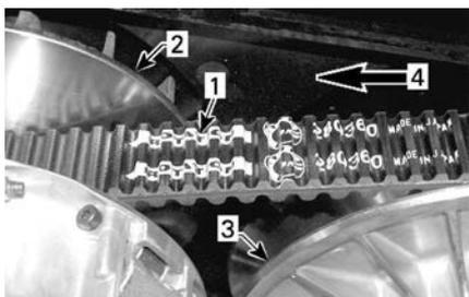
1. Flèche imprimée sur la courroie
