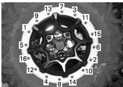
ТИПОВОЙ ВАРИАНТ - ПОРЯДОК ЗАТЯЖКИ ВИНТОВ
