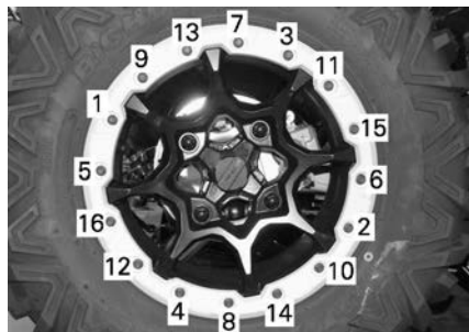
ТИПОВОЙ ВАРИАНТ - ПОРЯДОК ЗАТЯЖКИ ВИНТОВ
