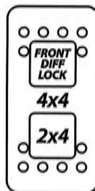
Este interruptor permite seleccionar el modo de tracción a 2 o a 4 ruedas con el vehículo parado y el motor funcionando.
