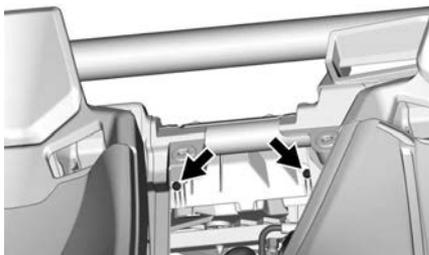
Desconecte la manguera del intercooler.
