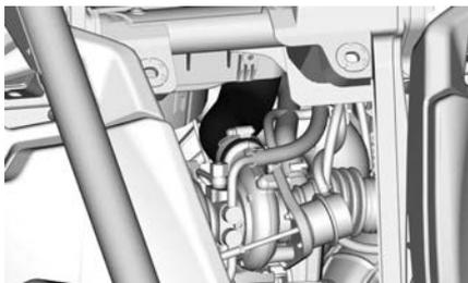
Abra el intercooler y el soporte del tubo del cárter del cigüeñal desmontando el tornillo.
