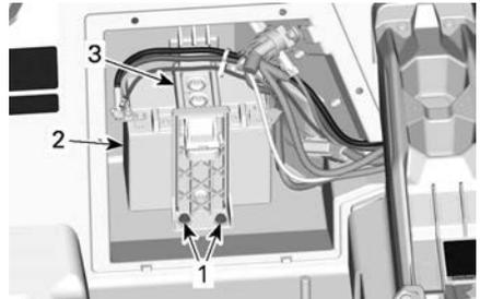
1. Tornillos de sujeción del portabaterías
