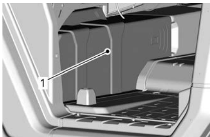
1. Couverture de la batterie
