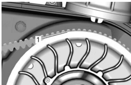
1. Porción más baja de los piñones alineada con el borde de la polea pasiva
