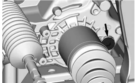
MIT INTEGRIERTEM 4WD-AKTUATOR
