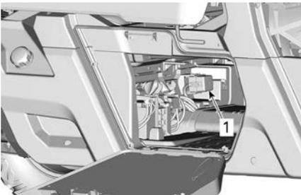
1. Hinterer Sicherungskasten
