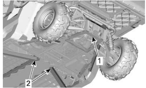
1. Hebestelle unter der Schutzplatte
