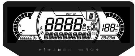
Diese Anzeige zeigt die Getriebestellung an:
