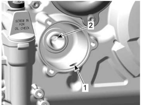
1. Einlass-Bohrung der Ölpumpe zum Ölfilter
