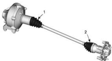
1. Soufflet d'arbre de transmission - côté différentiel
