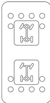
Le commutateur sélectionne le mode 4 roues motrices ou le mode 6 roues
