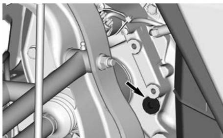
4. Retirez le bouchon de remplissage.
