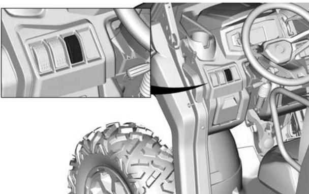
L'utilisation intensive du plateau motorisé peut causer la désactivation temporaire des disjoncteurs intégrés.
