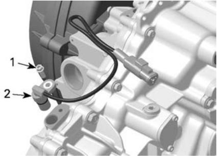
1. Vis du capteur de vitesse du véhicule (VSS)
