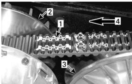
1. Flèche imprimée sur la courroie
