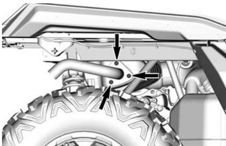
2. Déposez le tuyau d'échappement, le joint (mettre au rebut) et le pare-étincelles
