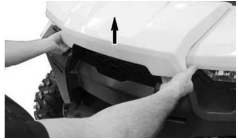
DE RAND VAN HET VOORSTE ONDERHOUDSDEKSEL OPTILLEN.
