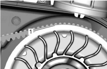
1. Unterster Teil der Zahnäder bündig mit der Abtriebsscheibenkante
