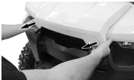
TIRARE DAL BORDO COPERCHIO DI MANUTENZIONE ANTERIORE.
