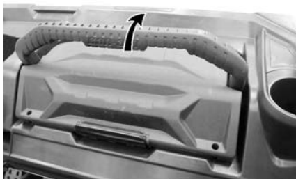
BLOCCO IN POSIZIONE DELLA CASSETTA DEGLI ATTREZZI
