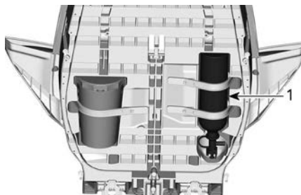
1. Extintor de incendios
