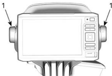
1. Винты для регулировки угла наклона
