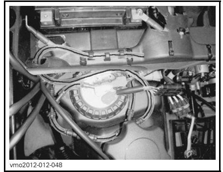
TARKASTA KAIKKI KIRKKAAT PUTKET
