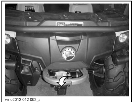
TYYPILLINEN - KIIINNITYSKOHTA TAKANA
