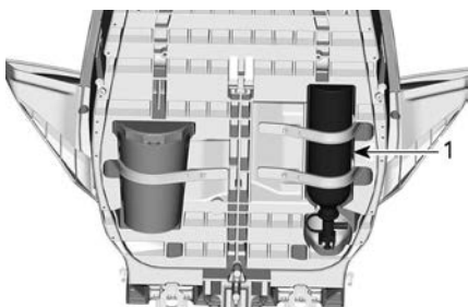
1. Extintor de incendios
