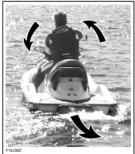
TYPBILD - STYRRIKTNINGEN OMKASTAD VID BACKNING
