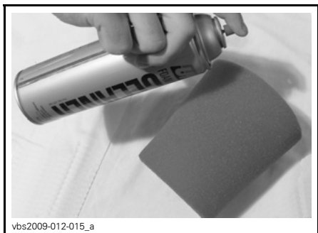
TÍPICO - ROCÍE EL FILTRO DE ESPUMA.
