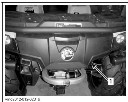
1. Tapa del compartimiento de almacenamiento trasero
