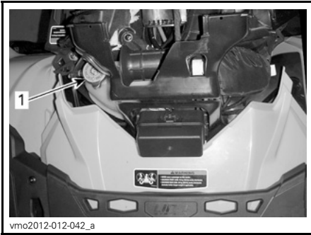
1. Depósito de refrigerante del motor
