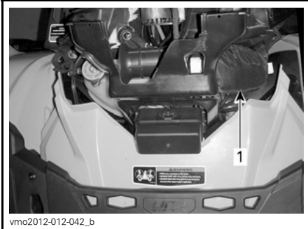
1. Filtro de aire de la CVT
