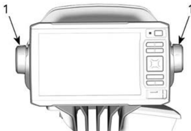
1. Винты для регулировки угла наклона
